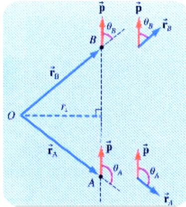
Le moment cinétique aux 2 points A et B est un vecteur qui sort de la page. Son module en ces points est  $L_A = r_A p \sin\theta_A$  et  $L_B = r_B p \sin\theta_B$ . On peut observer sur la figure ci-dessus que :
